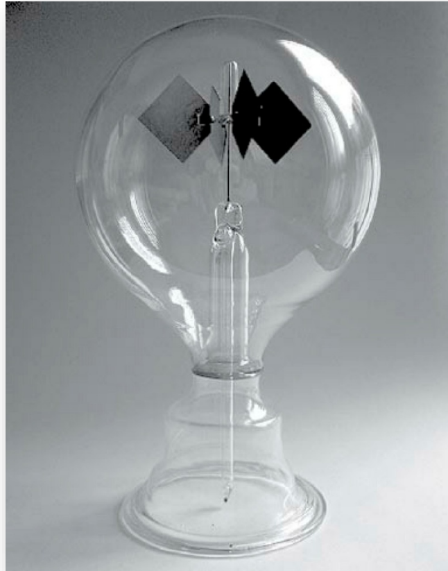
Fig. 1-3 Radiômetro de Crookes – a ventoinha com quatro pás gira quando a luz a ilumina.
